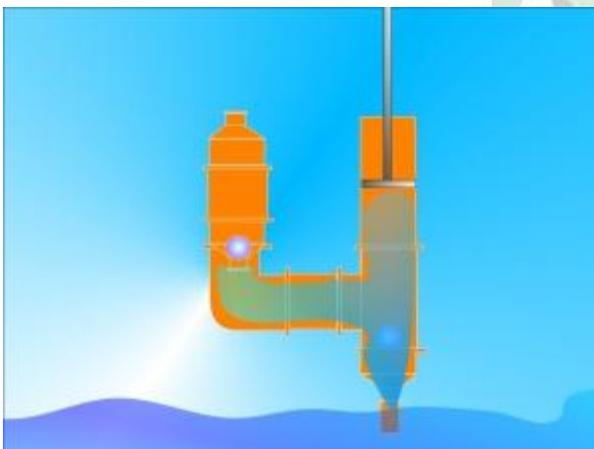
2. O pistão sobe reduzindo a pressão interna do cilindro, a válvula (bolinha) se abre e, dessa forma, a água é sugada para dentro da bomba d'água.
