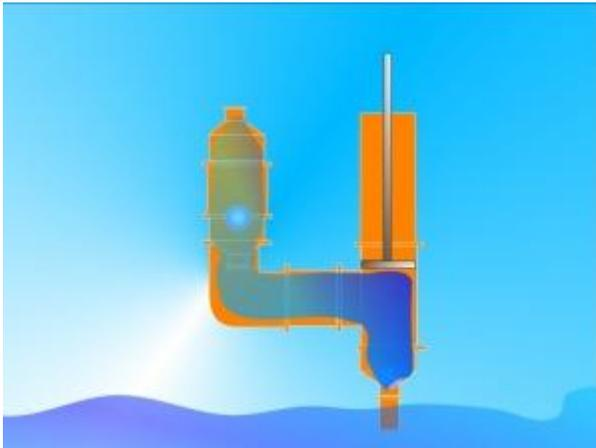
3 O pistão desce aumentando a pressão interna da bomba, a válvula de baixo se fecha e a superior se abre, redirecionando a água.
